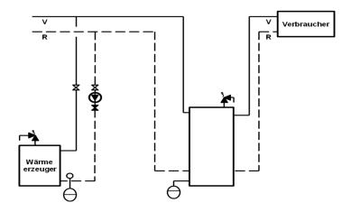
Abbildung 2 (Prinzipdarstellung – Hydraulikbeispiel Heizung)
