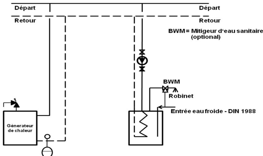
Figure 3 (Schéma de principe – Exemple d'installation hydraulique)
